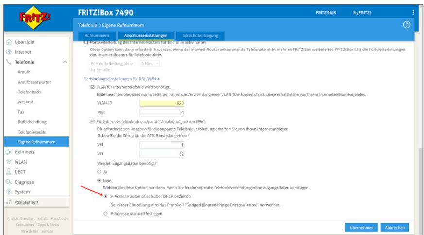
Abbildung 6 - IP-Adresse „automatisch über DHCP beziehen“
